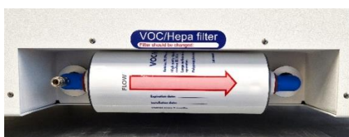
Obrázek 12.3 Správně nainstalovaný filtr VOC/HEPA
