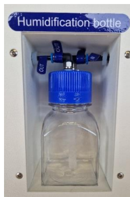
Obrázek 22.1 Připojení hadičky na zvlhčovací lahvi a vícekomorovém inkubátoru IVF Mini MIRI® Humidity
