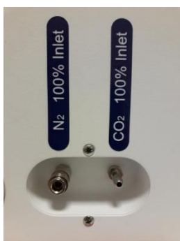
Obrázek 11.1 Vstupy pro plyny na zadní straně vícekomorových IVF inkubátorů Mini MIRI® Dry a Mini MIRI® Humidity
